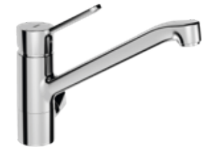
Einhebelmischer für Spültisch, topbedient, schwenkbarer Auslauf, Geräteabsperrentil, Höhe: 198 mm, Ausladung: 210 mm
