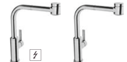
Einhebelmischer für Spültisch, seitenbedient, schwenkbarer Auslauf, 2-strahlige Ausziehbrause , Höhe: 345 mm, Ausladung: 221 mm
