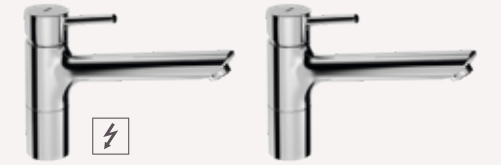
Einhebelmischer für Spültisch, topbedient, mit Pinhebel , schwenkbarer Auslauf, Höhe: 166 mm, Ausladung: 201 mm
