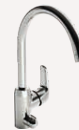
Einhebelmischer für Spültisch, seitenbedient, schwenkbarer Auslauf mit Spülmaschinenventil, Höhe: 355 mm, Ausladung: 213 mm
