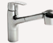
Einhebelmischer für Spültisch, topbedient, schwenkbarer Auslauf, Geschirrbrause, 2-strahlig herausziehbar, Höhe: 215 mm, Ausladung: 231 mm
